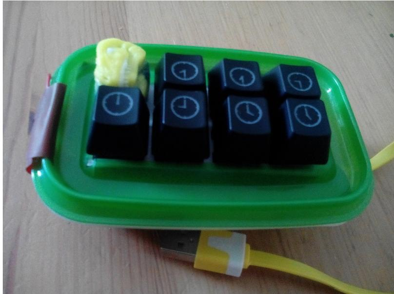
Abbildung 4.8: Prototyp mit Kunststoffgehäuse, Tasten
