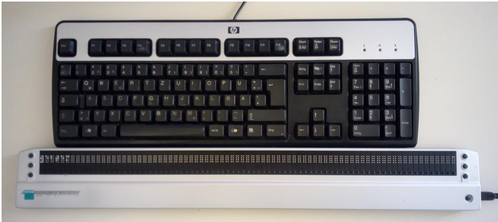
Abbildung 5.1: QWERTZ Tastatur mit Braillezeile
