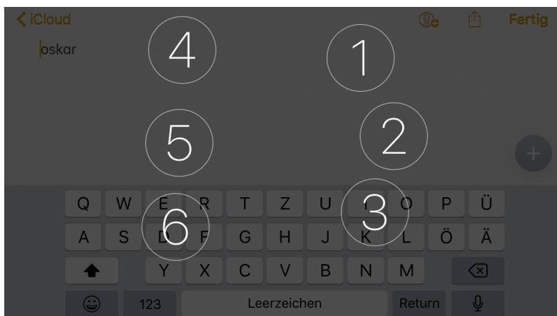
Abbildung 3.6: Virtuelle Brailletastatur, abgewandter Bildschirm Modus, Smartphone Betriebssystem iOS Version 11.3
